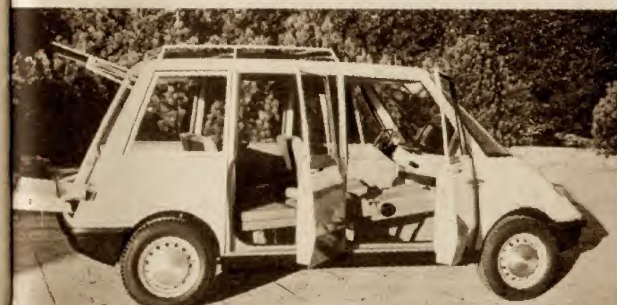
Der „Fam“ hat einen 60-PS-Vierzylinder-Motor von Glas, Hubraum 1281 ccm, Vierganggetriebe, Spitze 140 km/h. Er ist 3,40 m lang, 1,60 m breit. Wendekreisdurchmesser: nur 8,4 m!
